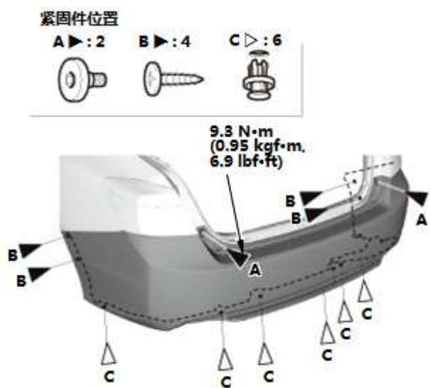
1. 拆下螺栓 (A)、螺钉 (B) 和卡扣 (C)。
